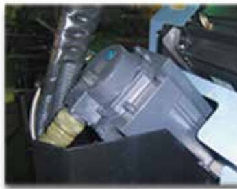
のこ刃位置を精密制御する Mitubishiサーボモーター
