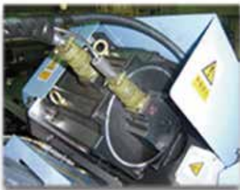
4.4kw 強力な切断サーボモーター
