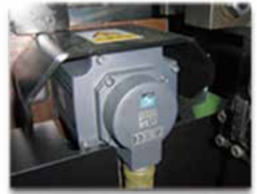
素材異動速度を制御する Mitubishiサーボモーター
