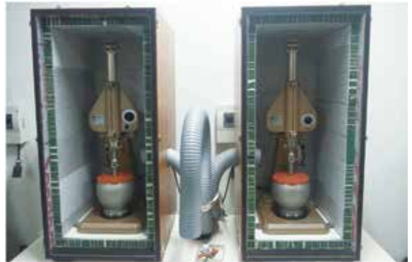
기존 상자 내부에 패널을 설치하여 기계소음 경감
