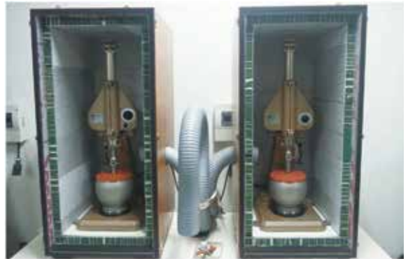
기존 상자 내부에 패널을 설치하여 기계소음 경감
