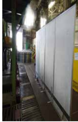
② 공장내 간이 방음벽 수치 : 2000mm×3000mm×높이2000mm 용도 : 귀마개 영역에서의 대책 효과 : 85dB → 75dB
