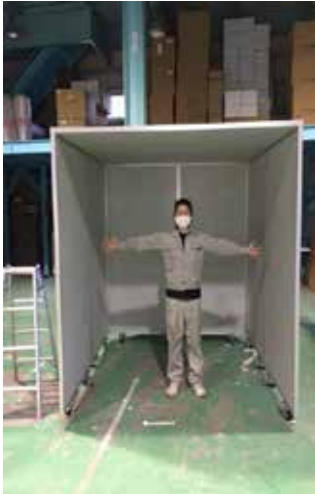
① 캐스터 부착 조립 방음부스 수치 : 2000mm×2000mm×높이2000mm 용도 : 내부에서 판금작업 수행
